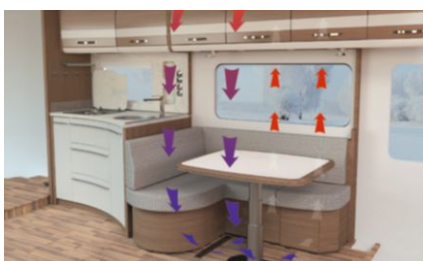
» AirPlus - ilma kiertää kaapistojen takaa ja ehkäisee kondenssiveden muodostumista
