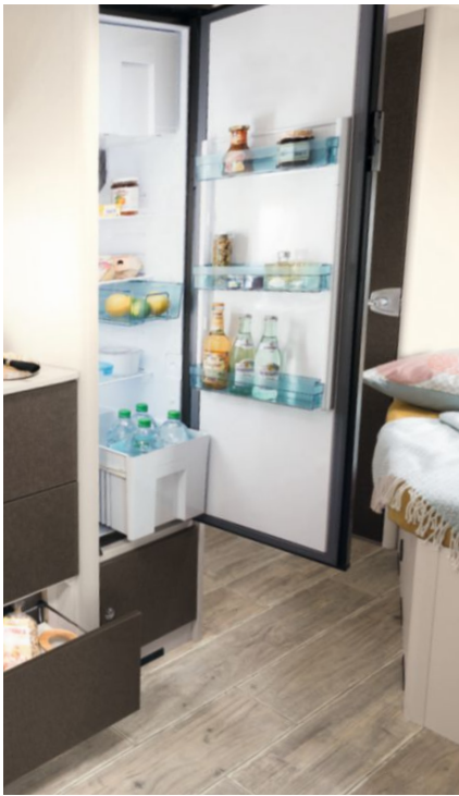
» 142 l kokoinen korkea jääkaappi, josta pakastelokero 15 l (mallista riippuen, ks. tekniset tiedot -taulukko)
