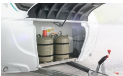
» Kaasupullokotelo kahdelle 11 kg pullolle, kotelon pohja kestävää ja tukevaa alumiini-turkkilevyä
