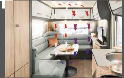
AirPlus-järjestelmän ansiosta ilma kiertää sisätiloissa yläkaapistojen takaa.
