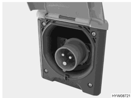
Kuva 58 230 V:n liitäntä ajoneuvolla (CEE-pistorasia)
