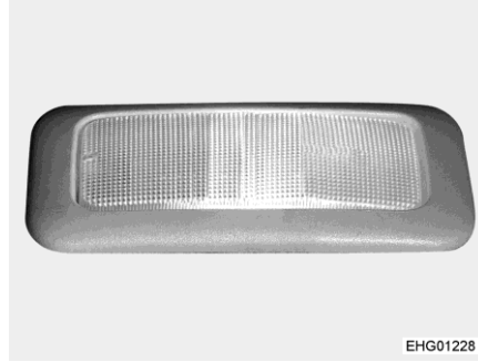
Kuva 33 Takaosan tavaratilan valaisin
